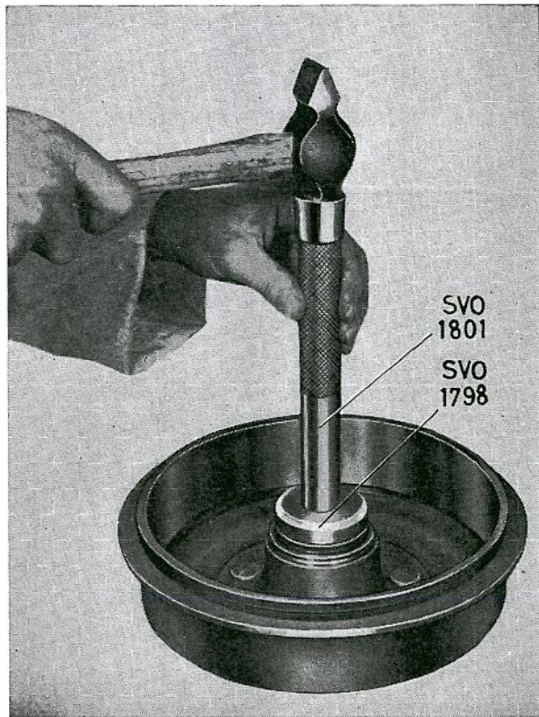
Bild 19. Mont. av tätningarring.
